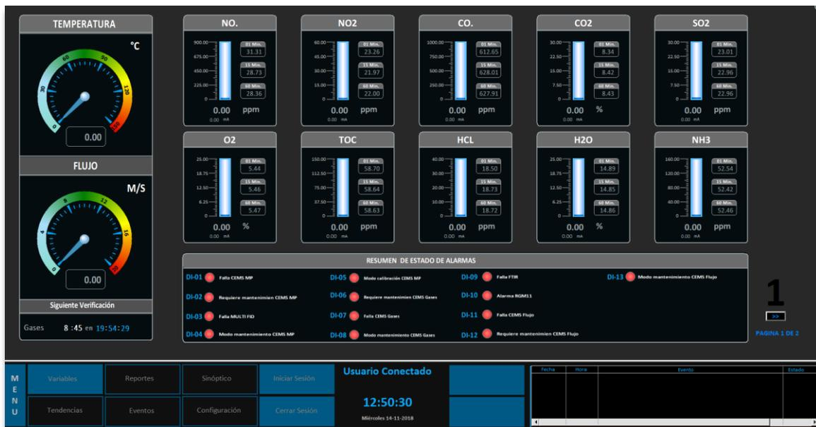
Fig.7. Pantalla principal de la HMI LINKit DAHS DS29
